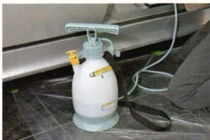
高压洗浄といって、エバボレーターのフィンを破損しない程度の圧で行う。使用しているのは、このハンドポンピングタイプの噴射器。電気を使わないので、店舗外でも施工できる。
