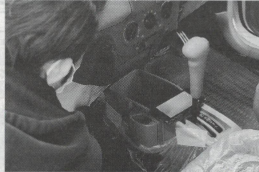
カメラ付きの特殊工具でエバポレーターに直接アクセスできる
